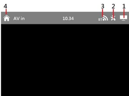
1. Toque para desligar a tela. Quando a tela for desligada, toque em qualquer parte da tela para ligar a tela.
