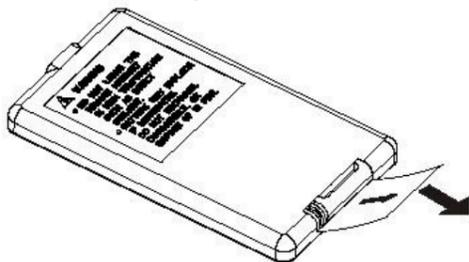
Quando a bateria acabar, por favor, substitua com bateria nova conforme mostra o desenho ao lado:
