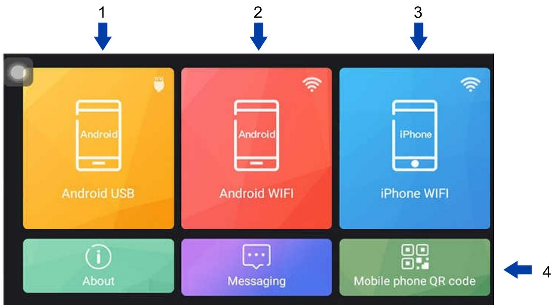
1. Toque para fazer o espelhamento via cabo USB em smartphones ANDROID (Não funciona em IOS ou espelhamento por cabo USB). *Para fazer o espelhamento é necessário instalar o aplicativo TIMA PHONELINK, link do aplicativo disponível no Mobile Phone QR code (4)*
