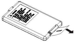
Quando a bateria acabar, por favor, substitua com bateria nova conforme mostra o desenho ao lado:
