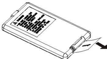
Quando a bateria acabar, por favor, substitua com bateria nova conforme mostra o desenho abaixo: (Modelo de Bateria:
